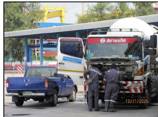
รูปที่ 79 เจ้าหน้าที่ตรวจสอบประสิทธิภาพและซ่อมบำรุงยานพาหนะขนส่งก๊าซทางบก
